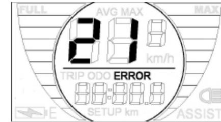
Im seltenen Fall einer Fehlfunktion des Systems kann im Display ein Fehlercode erscheinen. Falls ein Fehlercode erscheint, schalten Sie das System und den Akku vollständig AUS und wieder EIN. Falls der Fehlercode immer noch erscheint, wenden Sie sich an eine örtliche Fachwerkstatt / autorisierten Partner um Hilfe zu erhalten.
