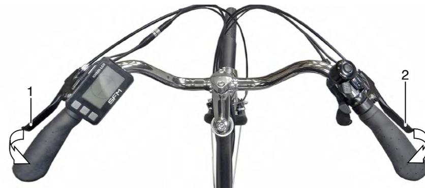
Handbremshebel (1) für Vorderradbremse
